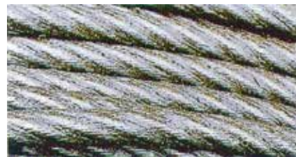
ワイヤーの耐食性は、メッキの種類、付着量、使用条件によって異なります。
